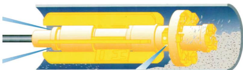
La fresa percutora está provista con cuchillas de metal duro intercambiables que fresan lo que encuentran con unas cadencias entre 600-3000 golpes por minuto y hasta 12.000 Kg. de fuerza de impacto.
